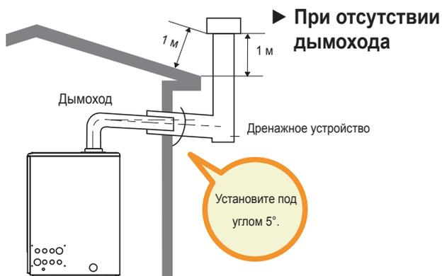
Труба должна устанавливаться на расстоянии не менее 1м над уровнем крыши. А на конечность необходимо установить Т-образную трубу от сильных ветров для поддержания стабильного горения.
