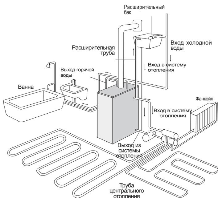
■ **Схема обвязки котла (в верхнем направлении)**
